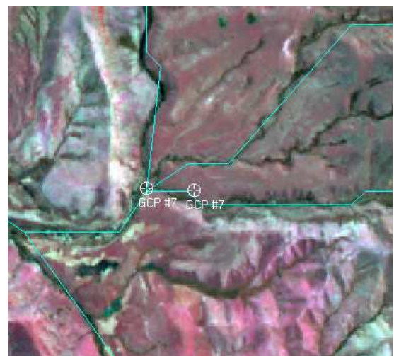
Illustration 11 : Calage des images SPOT sur le réseau Hydrologique Calculé (MNT) grâce au GCP Tool d'Erdas
